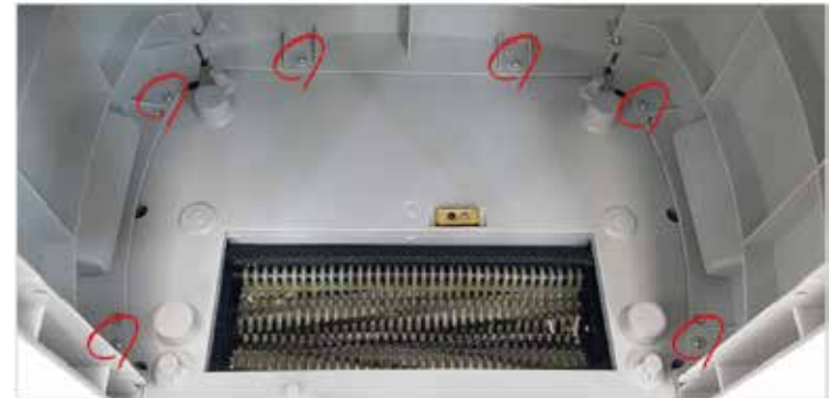
③ 위 사진에 표시된 것 처럼 기기 헤드부분에 있는 나사 6개를 모두 풀어주세요. (모델에 따라 나사의 갯수가 틀릴 수 있습니다.)
